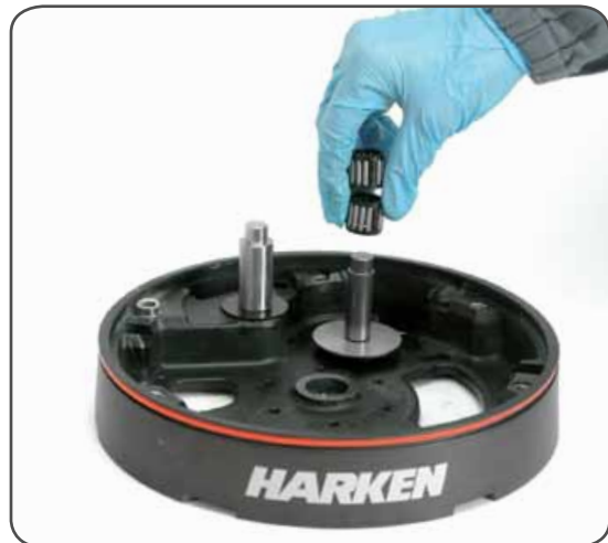
18. Remove roller bearings n°12
