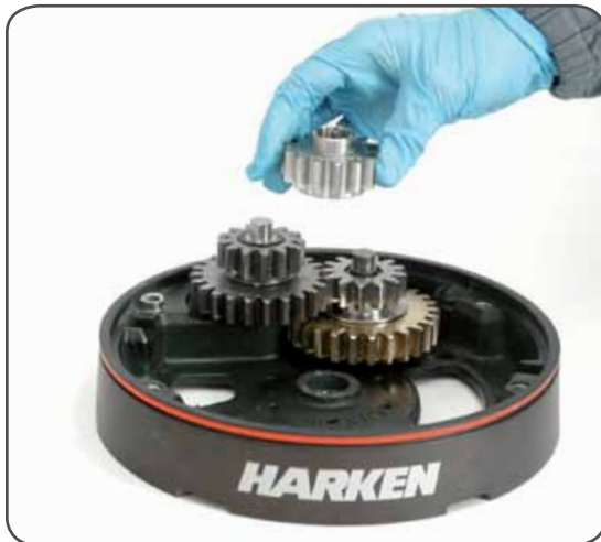
13. Remove the gear n°2
