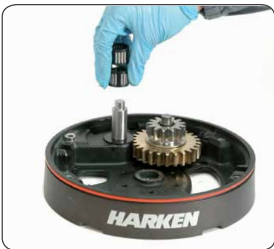
15. Remove roller bearings n°15
